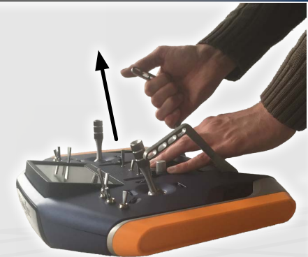
Bügel in die vertikale Position bringen
