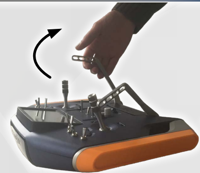
Bügel in die vertikale Position bringen
