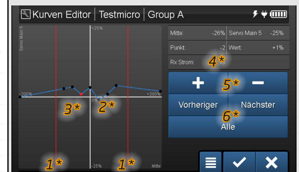
Das spezielle Kurveneditormenü für die Abweichungskurve eines Slave-Servos.
