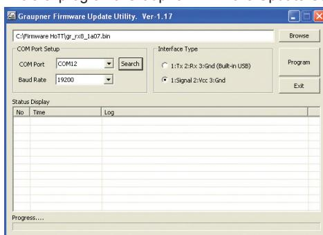
En la ventana [COM Port Setup] seleccionar el puerto COM correcto, es decir aquel en el que está conectado el cable USB. Si tiene dudas, abra, en WINDOWS, la aplicación System/Hardware/Gerätemanager. Seleccione “Silicon Labs CP210x USB to UART Bridge” y copie el puerto atribuido.
