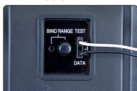
Conecte el adaptador, según muestra la foto, en la toma DATA situado en la parte posterior de la emisora. Las conexiones han sido preparadas para no poder equivocarse. No fuerce, debe poder conectar los cables sin esfuerzo.
