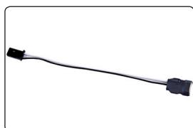
Corte el hilo de color rojo del cable adaptador Ref. Cde 7168 .6<sup>a</sup>. Conecte seguidamente el hilo al puerto USB Ref.Cde 7168.6. Las conexiones han sido preparadas para no poder equivocarse. No fuerce, debe poder conectar los cables sin esfuerzo.
