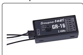
Conecte el cable adaptador, como muestra la foto, en la toma situada a la izquierda del receptor. Las conexiones han sido preparadas para no poder equivocarse. No fuerce, debe poder conectar los cables sin esfuerzo.
