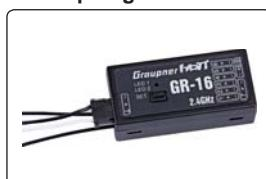
Stecken Sie das Adapter-Kabel wie in der Abb. gezeigt in die Buchse auf der linken Seite des Empfängers. Das Stecksystem ist verpolungssicher, achten Sie auf die kleinen seitlichen Phasen. Wenden Sie auf keinen Fall Gewalt an, der Stecker sollte leicht einrasten.
